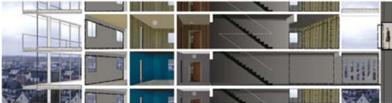
Ajout de balcon en béton préfabriqué sur corbeaux métallique
